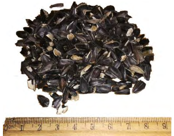
неповністю виповнені і пусті \rho = 248 \pm 19 \text{ кг/м}^3 , V_a = 6,8 \pm 0,5 \text{ м/с}
