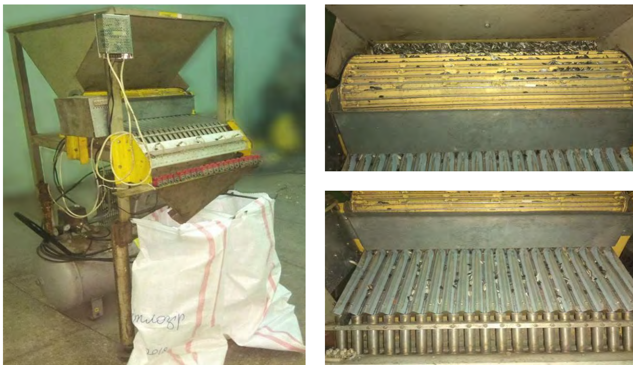
Рисунок 5.33 – Загальний вигляд експериментального стенду фотоелектронного сепаратора із автоматизованою системою керування режимних параметрів блока подачі насіннєвого матеріалу
