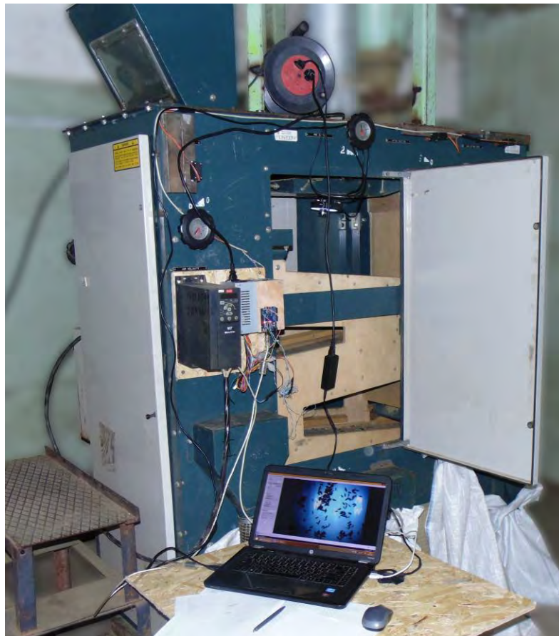
Рисунок 5.20 – Загальний вигляд експериментального адаптивного віброрешітного сепаратора
