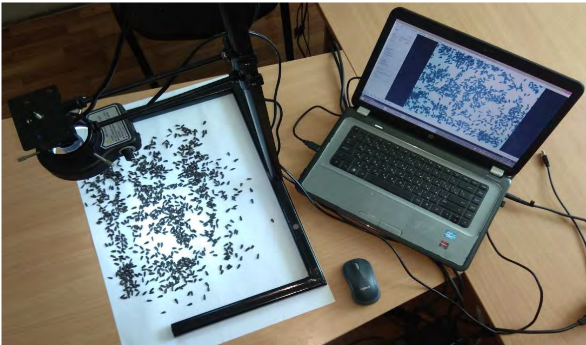
Рисунок 5.17 – Загальний вигляд спеціалізованого штатива із фотокамерою ELP-USBFHD01M-BFV і джерелом світла
