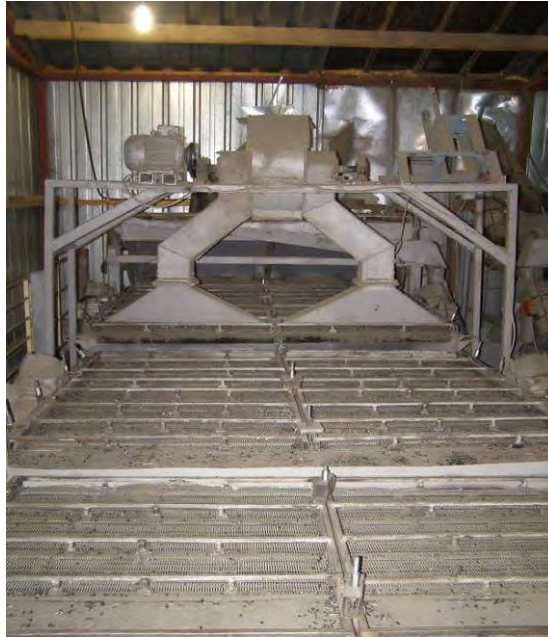
Рисунок 4.10 – Процес дослідження розділення насінневого матеріалу соняшнику на калібрувальній машині ОКМФ
