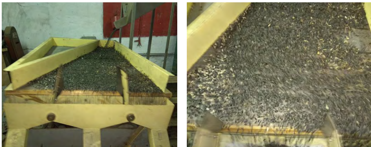
Рисунок 4.15 – Процес дослідження розділення насінневого матеріалу соняшнику на пневмовібростолі типу ПВС
