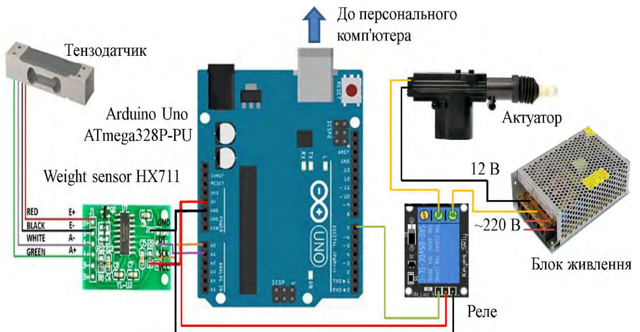
Рисунок 5.26 – Електрична схема керування блока вимірювання об'ємної маси
