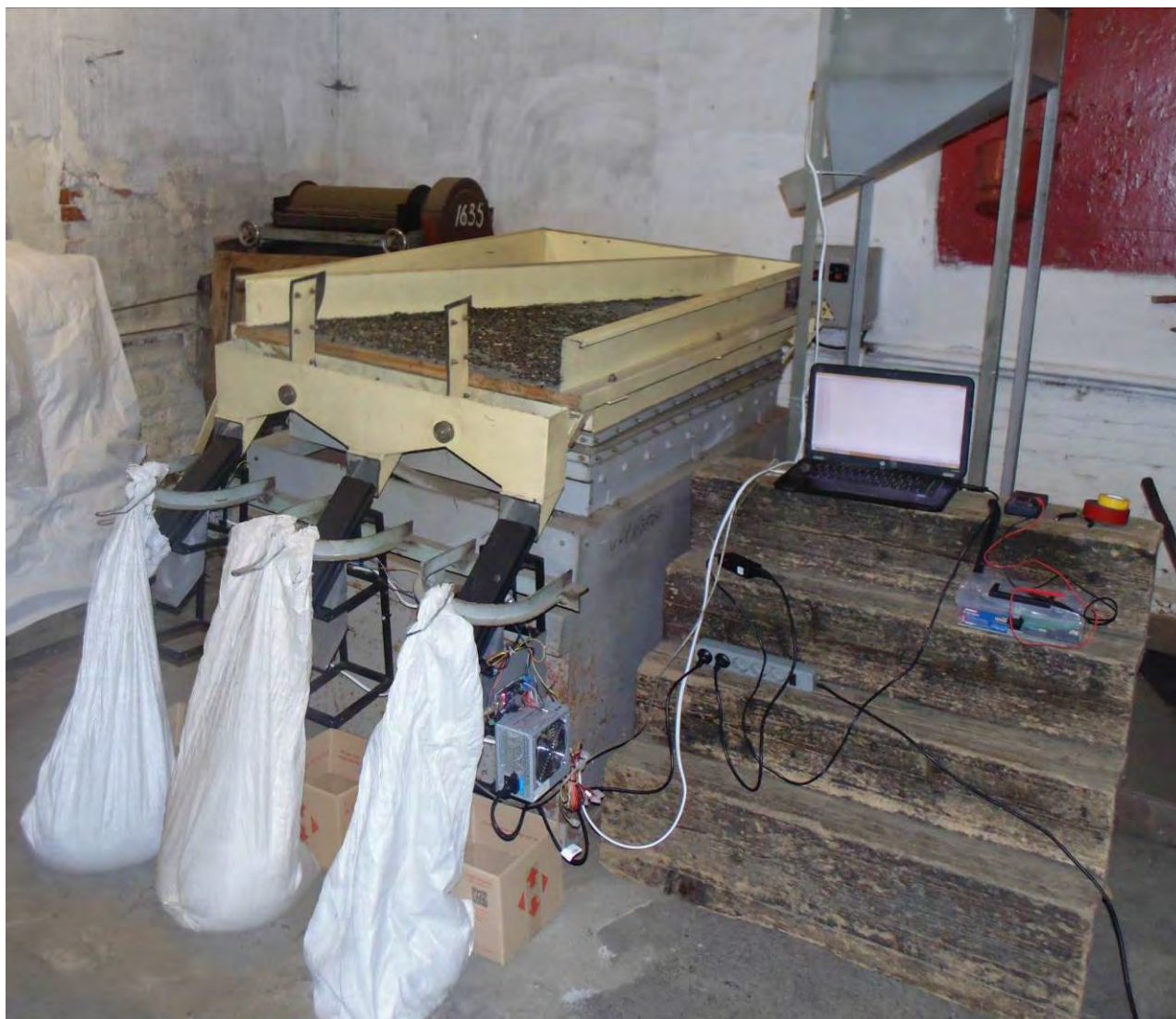
Рисунок 5.28 – Загальний вигляд експериментального адаптивного вібропневматичного сепаратора
