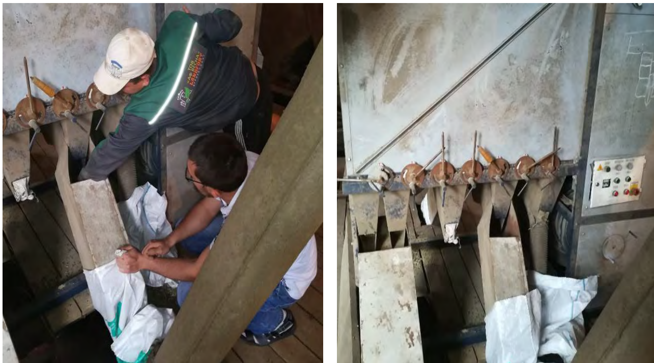
Рисунок 4.6 – Процес дослідження розділення насінневого матеріалу соняшнику на аеродинамічному сепараторі серії «Алмаз»
