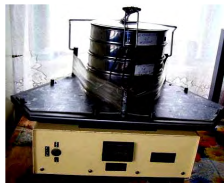
Рисунок 3.5 – Конструктивно-технологічна схема (а) і загальний вигляд (б) експериментального стану на базі калібрувальної машини ОКМФ
