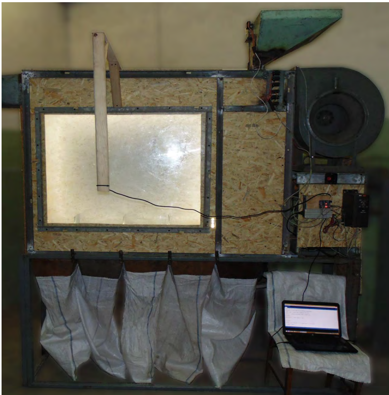
Рисунок 5.11 – Загальний вигляд експериментального зразка адаптивного аеродинамічного сепаратора
