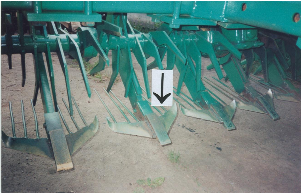
Рис. 3.9. Підрізаюче-підйомні робочі органи експериментальної польової роторної ґрунтообробної установки
