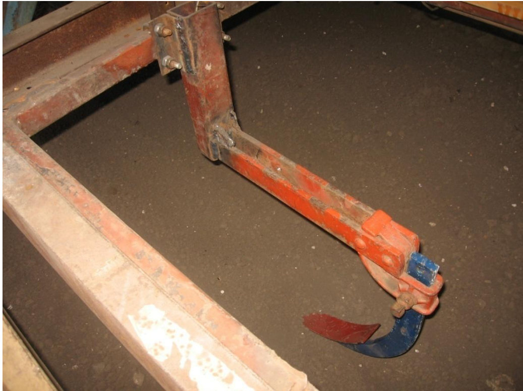
Рис. 3.2. Кріплення стійки робочого органу в утримувачі малого візка
