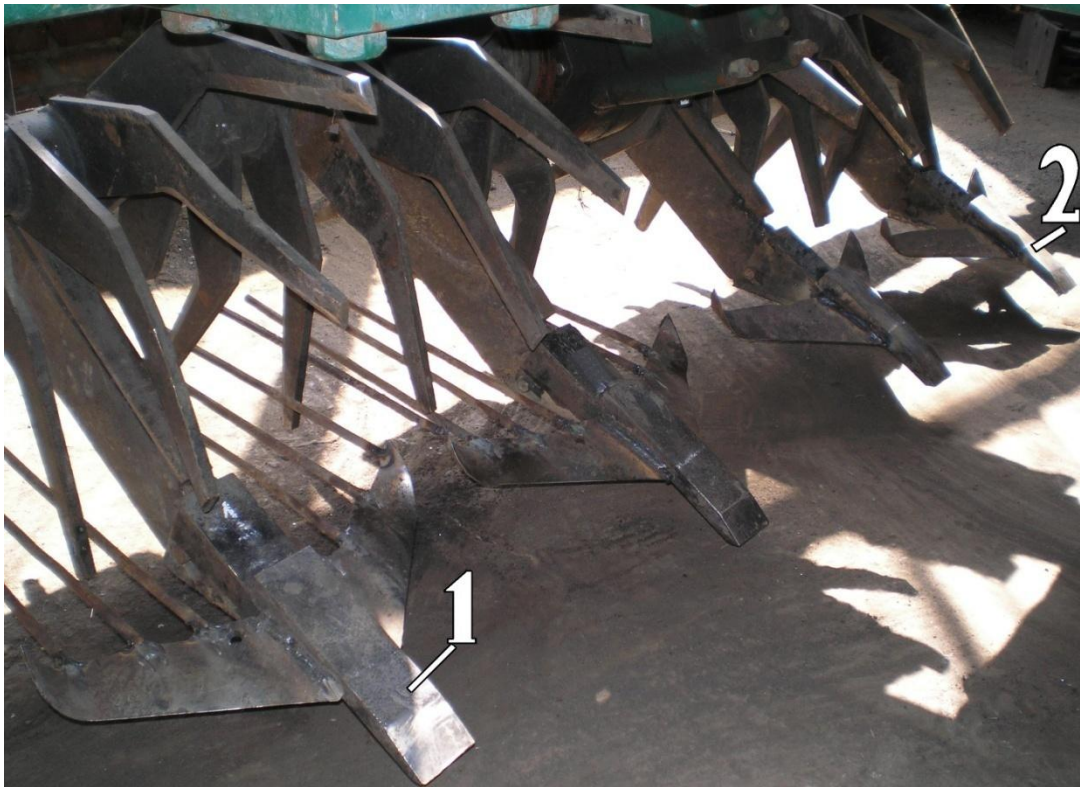
Рис. 3.10. Загальний вигляд робочих органів експериментальної установки: 1 – плоскоріжуча стрілочаста лапа з наральником теоретично обґрунтованої форми та сепаруючою решіткою; 2 – плоскоріжуча стрілочаста лапа з наральником теоретично обґрунтованої форми без сепаруючої решітки
