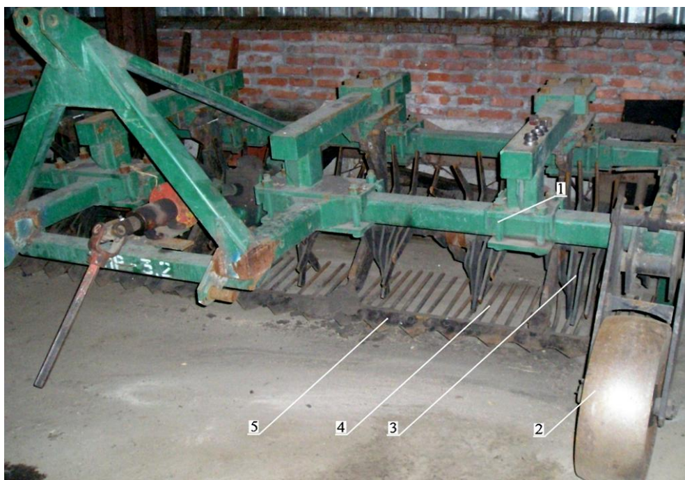
Рис. 1.4. Машина для обробки орного шару ґрунту: 1 – рама; 2 – опорні колеса; 3 – ротор; 4 – сепаруюча решітка; 5 – леміш
