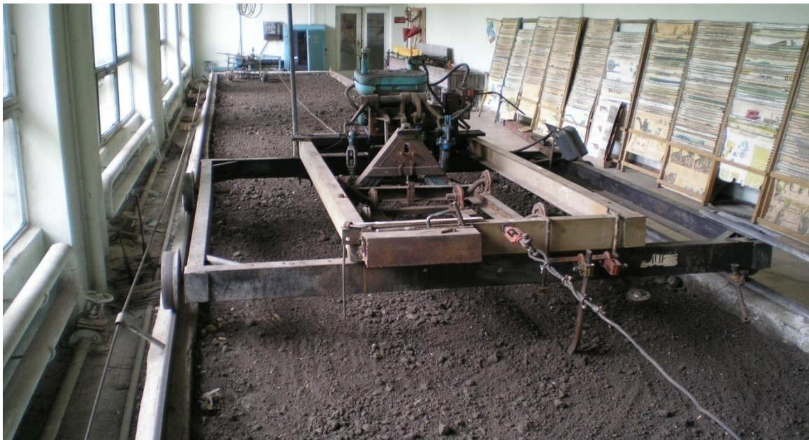
Рис 3.1. Загальний вигляд ґрунтового каналу та експериментальної лабораторної установки
