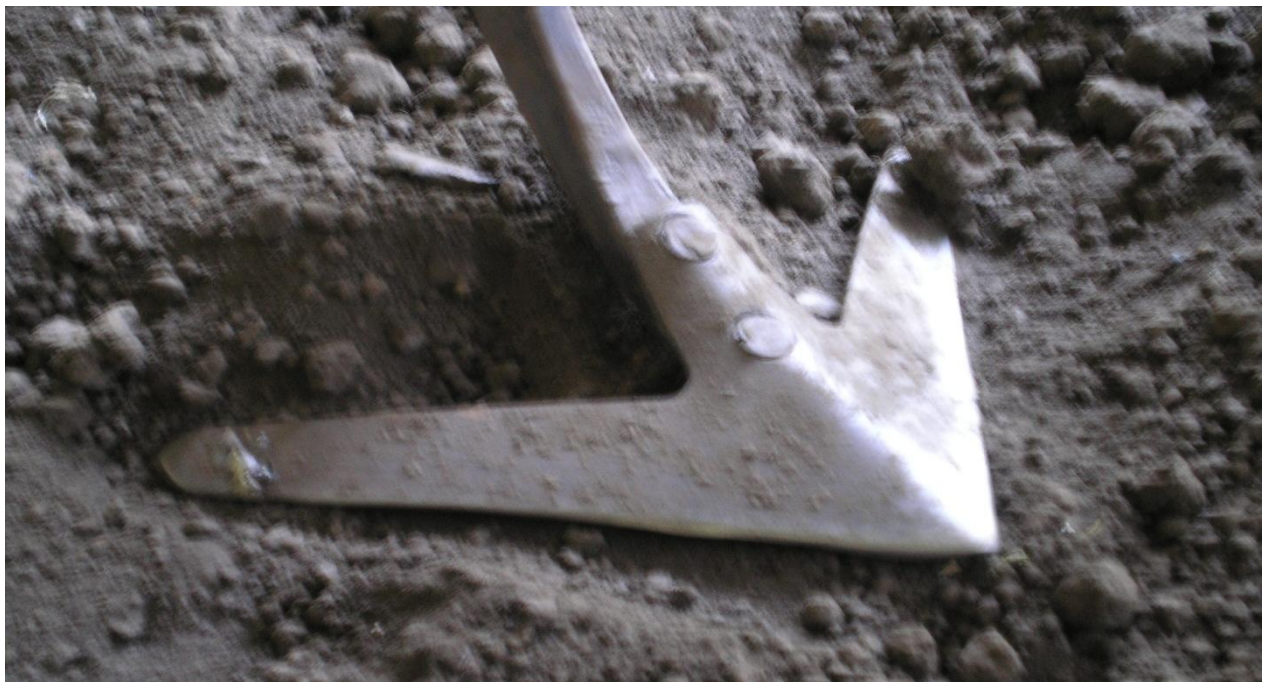
Рис 3.12. Плоскоріжуча стрілчаста лапа шириною 370 мм
