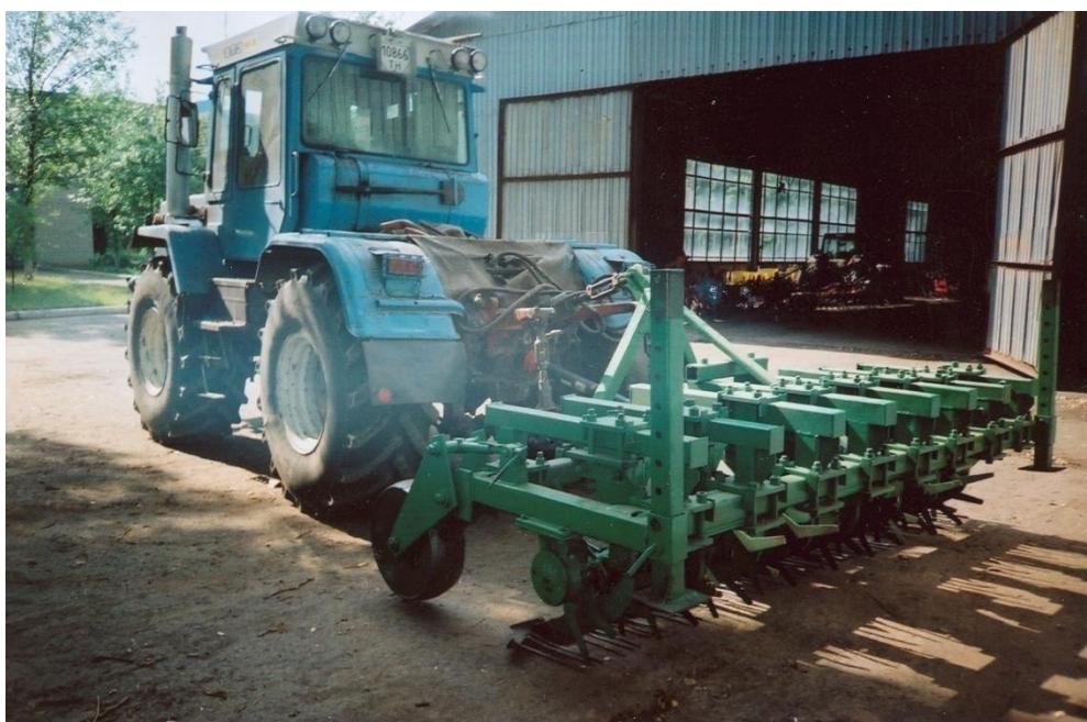
Рис. 3.5. Загальний вигляд експериментальної польової роторної розрихлювально-сепаруючої установки в агрегаті з трактором Т-150К-08
