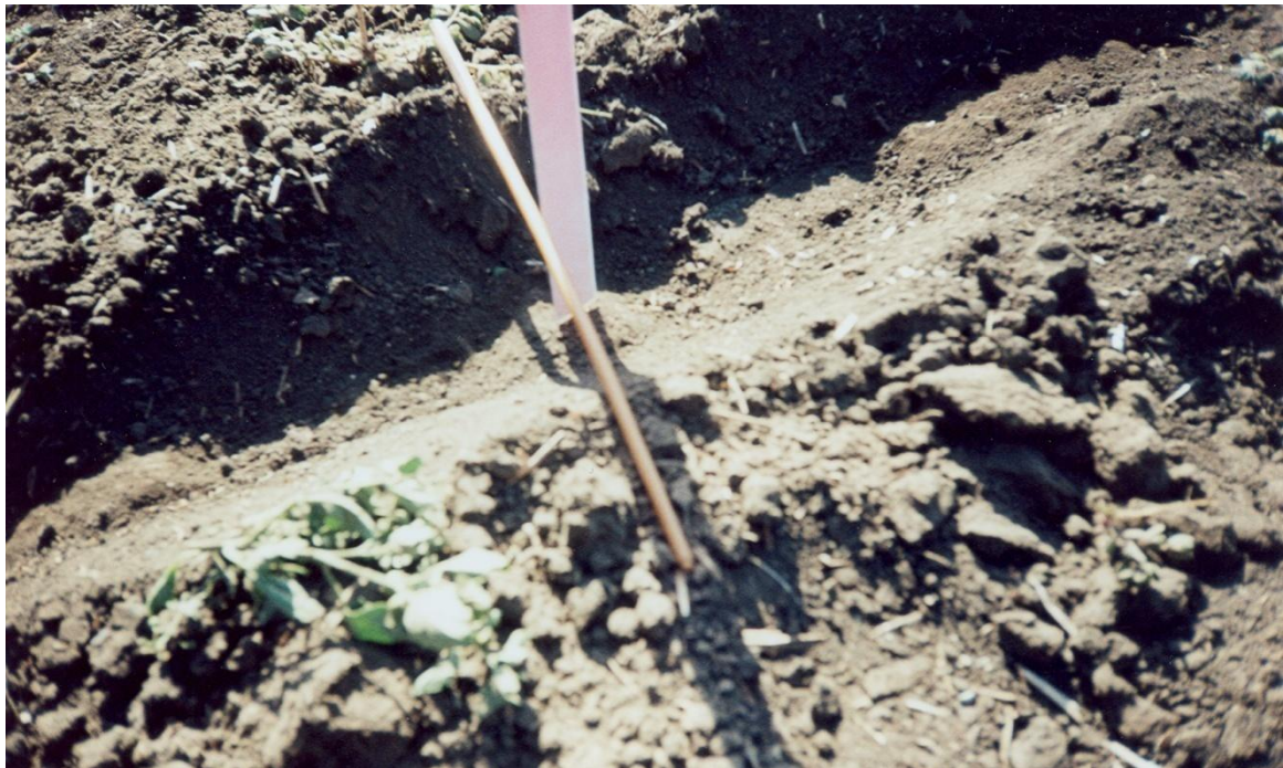
Рис. 3.14. Визначення глибини борозни після проходу експериментального підрізаюче-підйомного пристрою
