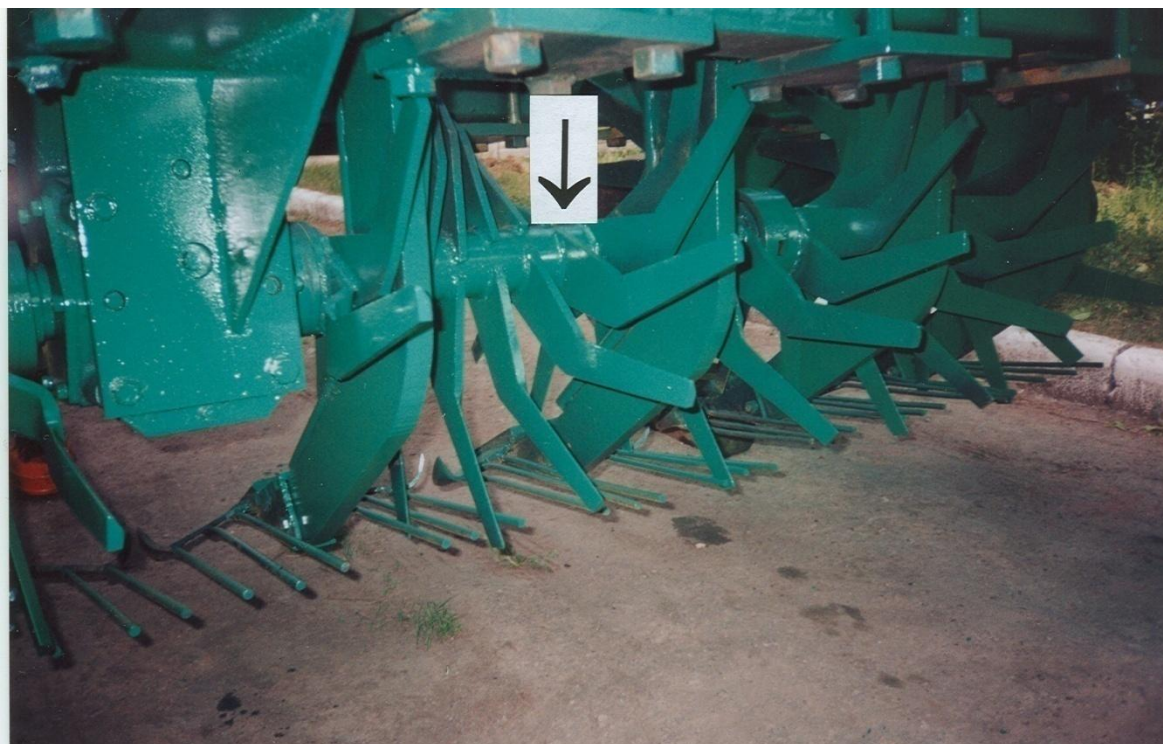
Рис. 3.8. Ротор експериментальної польової ґрунтообробної установки
