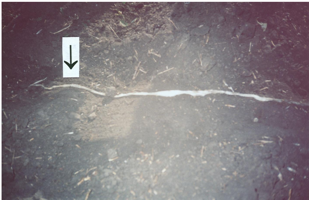
Рис. 4.3. Вид дна борозни після проходу експериментальних підрізаюче-підйомних робочих органів
