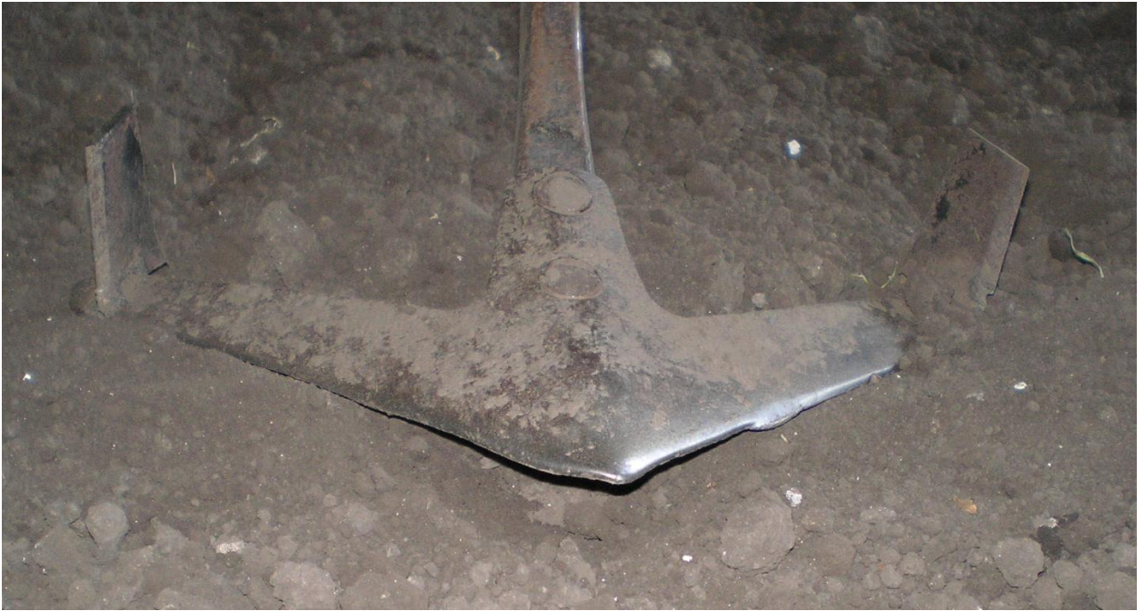
Рис 3.13. Експериментальний підрізаюче-підйомний робочий орган
