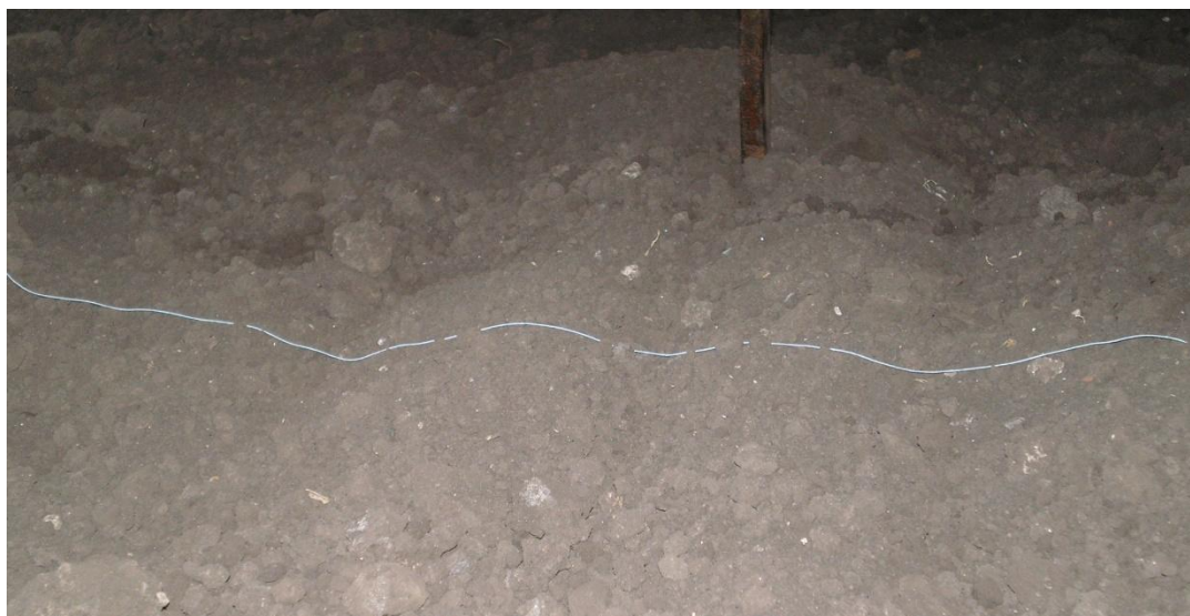
Рис. 4.2. Вид поверхні ґрунту після проходу експериментального підрізаюче-підйомного робочого органу
