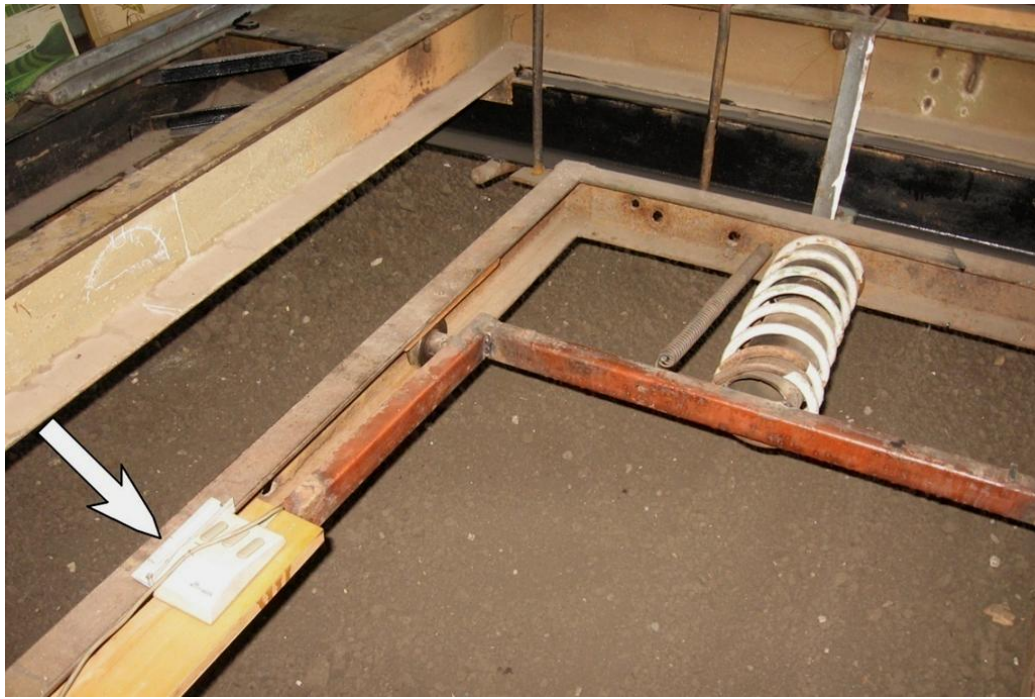
Рис. 3.3. Рухомий візок зі спеціально підготовленим датчиком (комп'ютерна миша)
