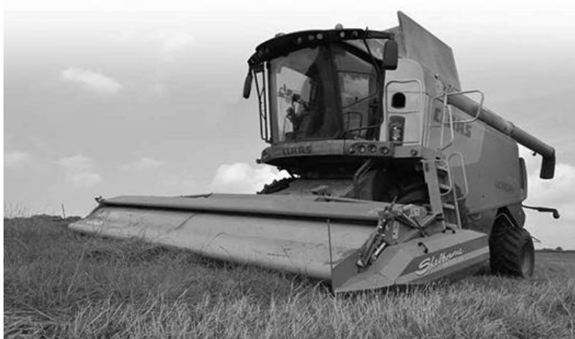
Рисунок 1.7 – Обчісувальна жниварка «Шелборн» (Велика Британія)
