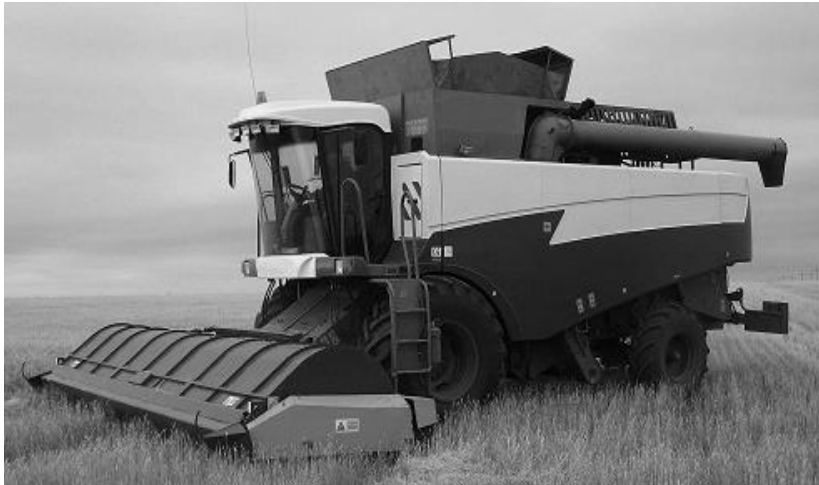
Рисунок 1.6 – Двобарабанна обчісувальна жниварка «Слов'янка» (Україна)
