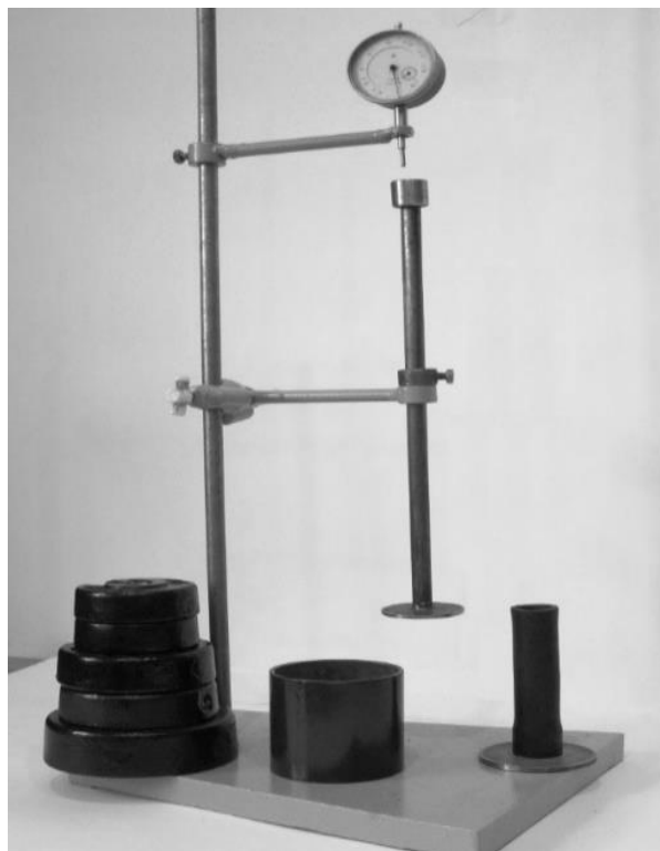
Рисунок 3.12 – Загальний вигляд приладу для визначення коефіцієнта Пуассона і модуля Юнга насіння льону олійного
