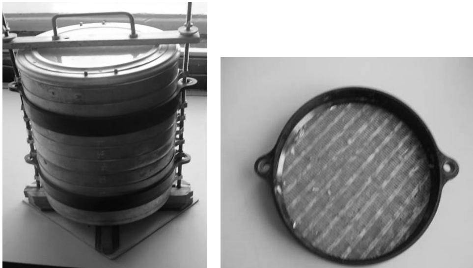
Рисунок 3.8 – Лабораторний решітний класифікатор та решета
