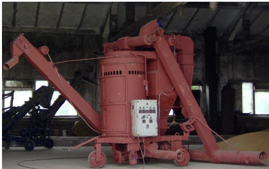
Рисунок 5.4 – Конструктивна схема модернізованого сепаратора СВС-25М
