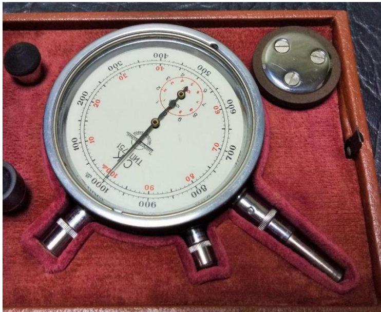
Рисунок 3.7 – Визначення частоти обертів годинниковим тахометром СК 751
