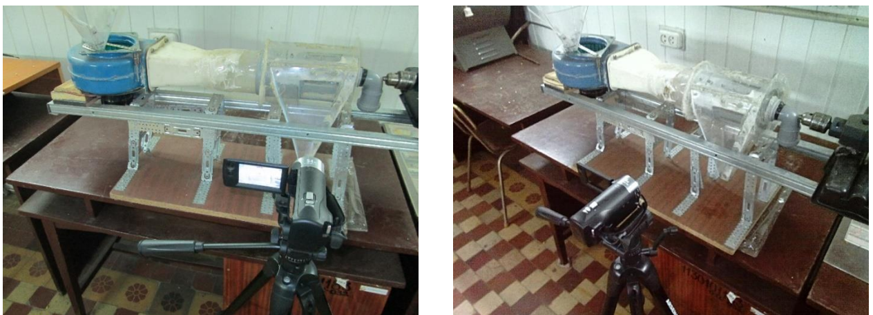
Рисунок 3.14 – Відеозйомка процесу очищення запиленого ПП в розробленому РЦ
