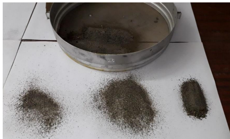
Рисунок 3.11 – Визначення дисперсності пилу за допомогою сит з отворами різного розміру
