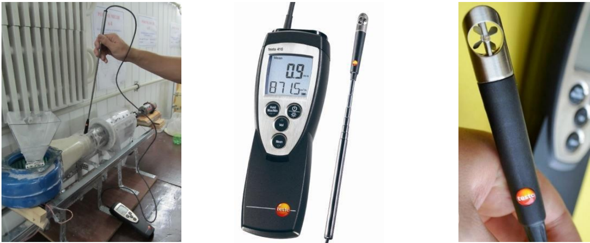
Рисунок 3.13 – Визначення швидкості ПП термоанемометром Testo 416
