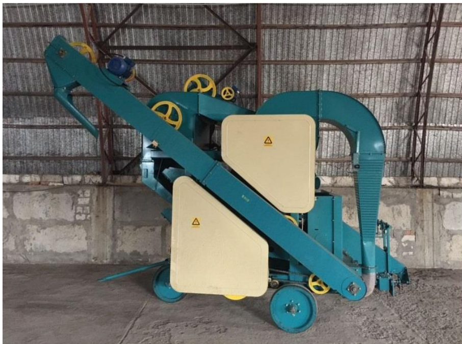
Рисунок 5.2 – Виробничі випробування модернізованого сепаратора ОВС-25М з розробленим РЦ
