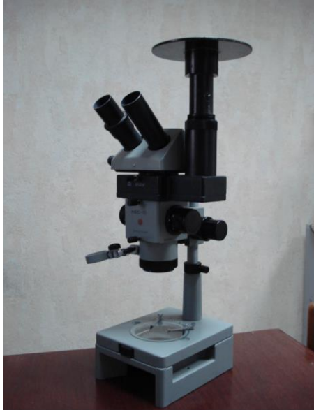
Рисунок 3.12 – Вимірювання дисперсності частинок пилу мікроскопом моделі МБС-9
