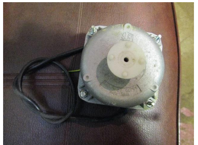
Рисунок 5.7 – Електродвигун розробленого РЦ
