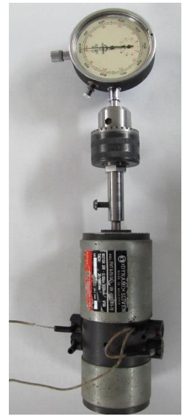
Рисунок 3.7 – Визначення частоти обертів годинниковим тахометром СК 751
