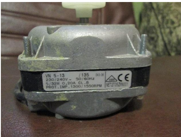
Рисунок 5.7 – Електродвигун розробленого РЦ
