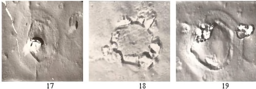
Рисунок 3.22 - Електронні мікрофотографії структури ямок травлення та рельєфу, навколо одиничне розтравленої дислокації карбідної фази (фотографії 17-19) хромонікелевого валкового чавуну, \times 4700 . Вакуумне травлення
