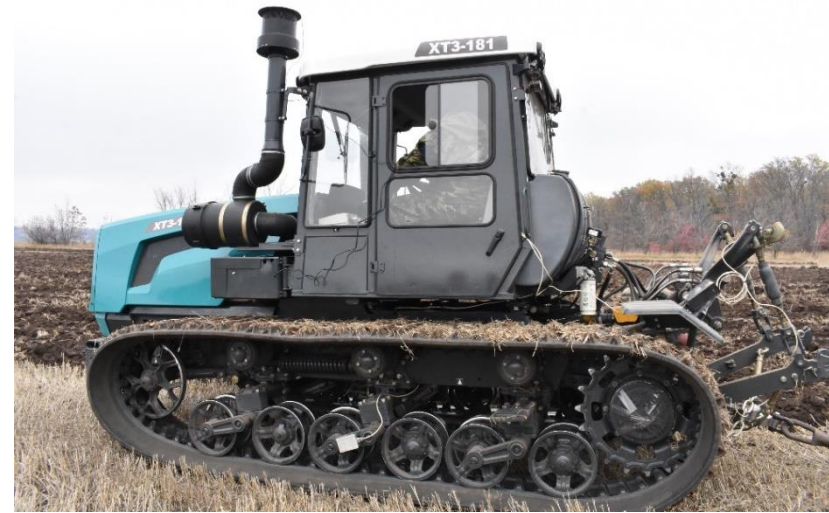
Рис. 4.14 – Тягові випробування трактора ХТЗ-181.20-07
