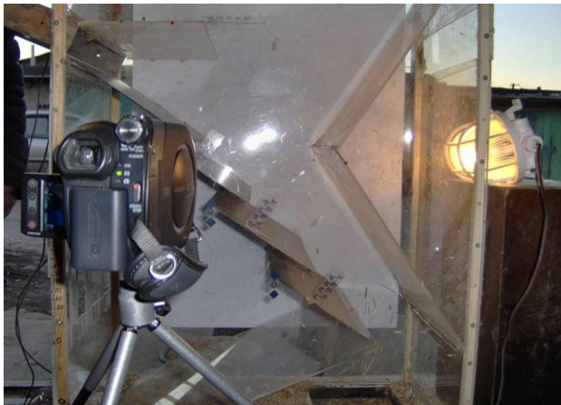
Рис. 3. Відеозйомка процесу очищення зернового матеріалу від частинок легких домішок
