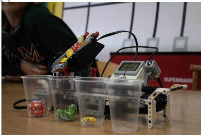
Рис. 1. Lego – модель стрічкового конвеєра з роботом, який сортирує цукерки за кольором, беручі їх зі стрічки
